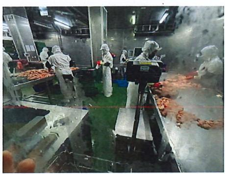
透過觀景窗觀看分切作業區作業情形-作業區維持約12~15度溫度，降低微生物汙染與繁殖。
